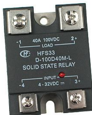
Obr. 7. SSR relé (kontakty 1-2 spínací max 40/100Vdc, 3-4 napájecí 4-32Vdc)
