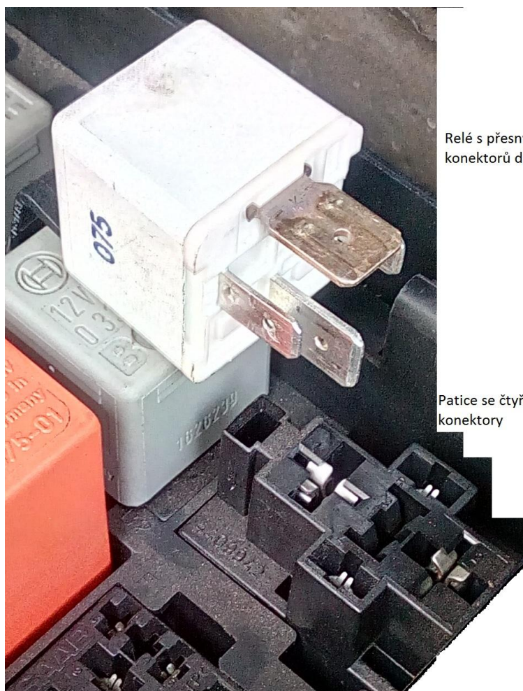
Obr. 11. Relé s paticí v pojistkové skříni automobilu s příslušným kódováním polohou
